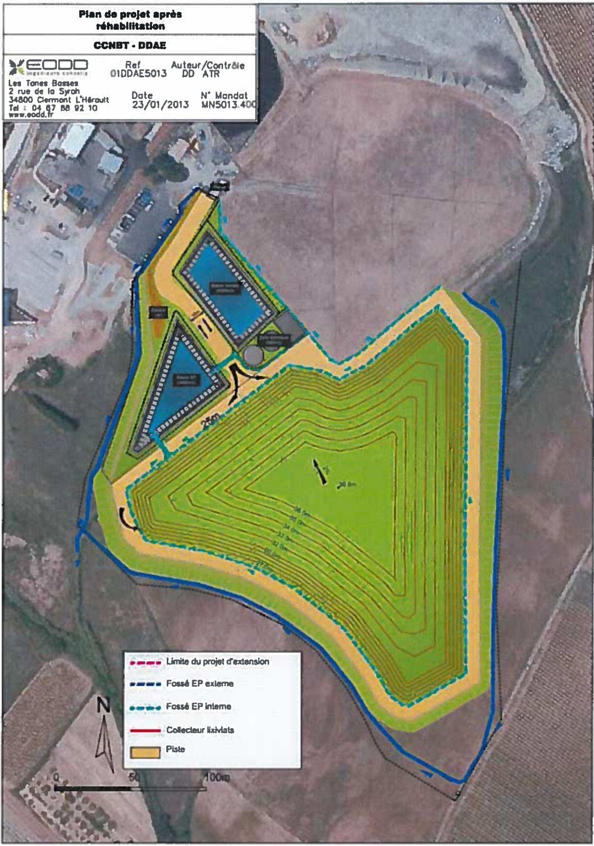
Figure 26 : Plan masse du projet réhabilité
